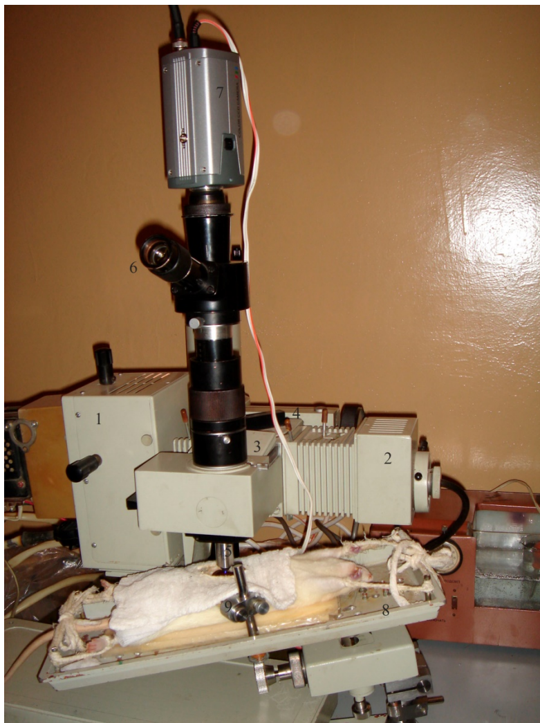
Рис. 2.4. Загальний вигляд мікроскопа «Люам К-1» з відеокамерою для дослідження мікроциркуляції in vivo
